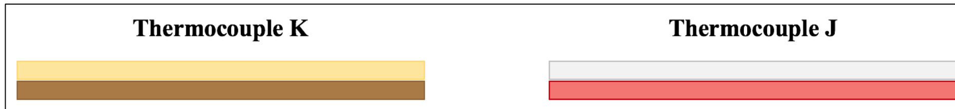
Figure 4 – Différence visuelle entre thermocouple K & J
